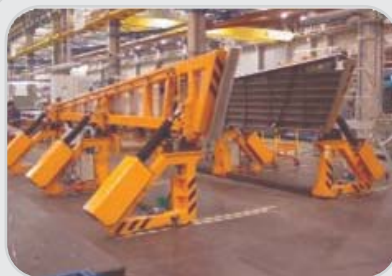
Programa: Airbus A-320 Cliente: Airbus Descripción: Grada automática de montaje HTP
