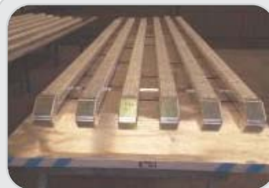
Programa: Airbus A-340 Cliente: Airbus Descripción: Utillaje conformado en caliente larguerillos HTP
