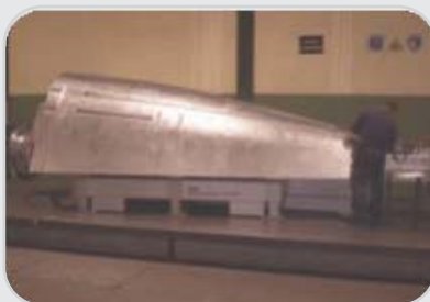
Programa: Airbus A-350 XWB Cliente: Alestis Descripción: Utillaje ensayo roto-encintado sección 19.1
