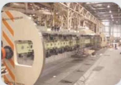
Programa: Airbus A-380 Cliente: Airbus Descripción: Grada automática de equipado de largueros HTP
