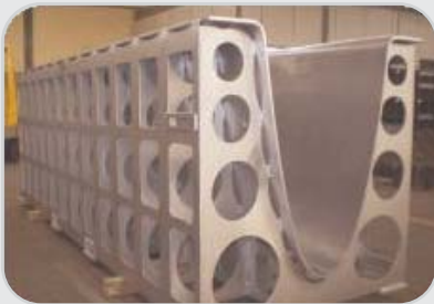
Programa: Airbus A-350 XWB Cliente: Aciturri Descripción: Utillaje curado borde ataque VTP
