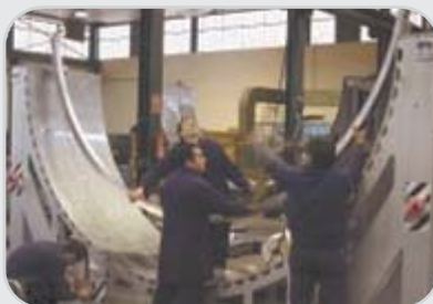
Programa: Airbus A-380 Cliente: Eads-Casa Descripción: Utillaje curado revestimientos motor con refuerzos
