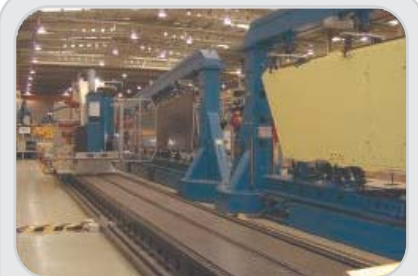
Programa: Airbus A-340 Cliente: Airbus Descripción: Grada automática multi-flexible para taladrado y remachado.HTP
