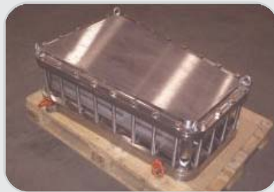
Programa: Airbus A-350 XWB Cliente: Aernnova Descripción: Utillaje RTM para curado de bearing ribs HTP
