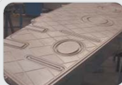
Programa: Eurocopter NH-90 Cliente: Aries-Complex Descripción: Utillaje recanteo revestimientos con sistema de canales de vacío
