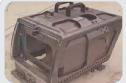
Programa: Airbus A-380 Cliente: Sacesa Descripción: Utillaje recateo sistemas belly fairing
